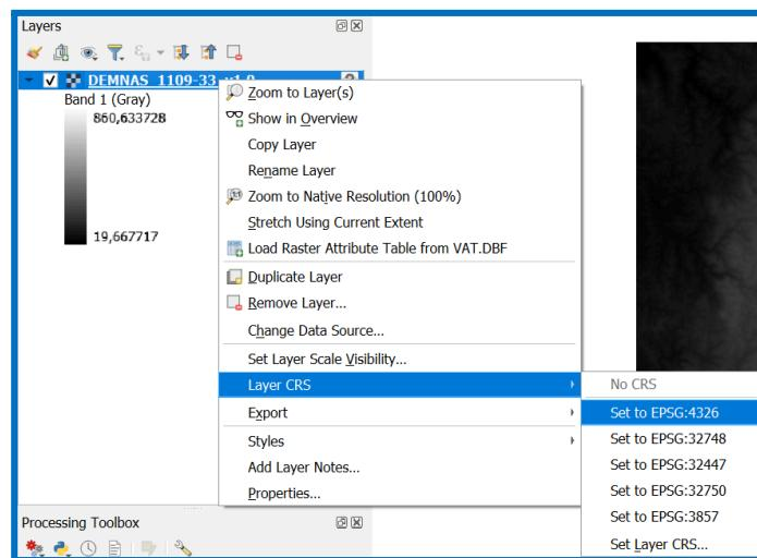
Klik kanan pada layer DEM > Klik Layer CRS > Atur sistem proyeksi (CRS) menjadi **EPSG:4326** (GCS WGS 1984)
