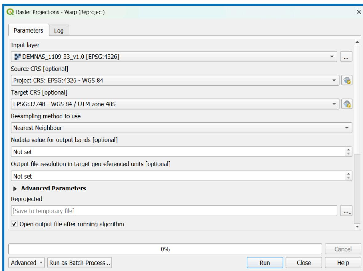
Atur **Input layer** dengan DEM > Atur **Source CRS** dengan EPSG:4326 - WGS 84 > Atur Target CRS menjadi UTM (Sesuaikan dengan UTM Zone di lokasi Anda) – DEM saya ada di wilayah Banten, saya menggunakan **EPSG:32748 - WGS 84 / UTM Zone 48S** > Sisanya *default* saja
