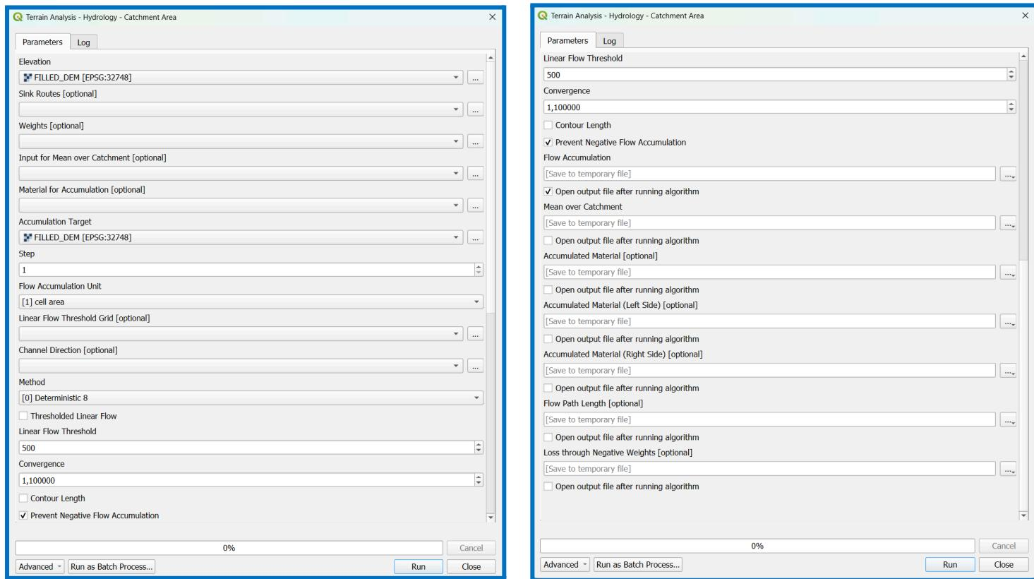
Cari tools **Catchment Area** pada Processing Toolbox, **jangan pilih tools Catchment Area (flow tracing) atau (recursive)** > Masukkan layer “**FILLED\_DEM**” ke parameter **Elevation** dan **Accumulation Target** > Biarkan parameter lain *by default* saja > *Unchecklist* seluruh output file parameter kecuali output **Flow Accumulation** > Atur file penyimpanan > Klik **Run**
