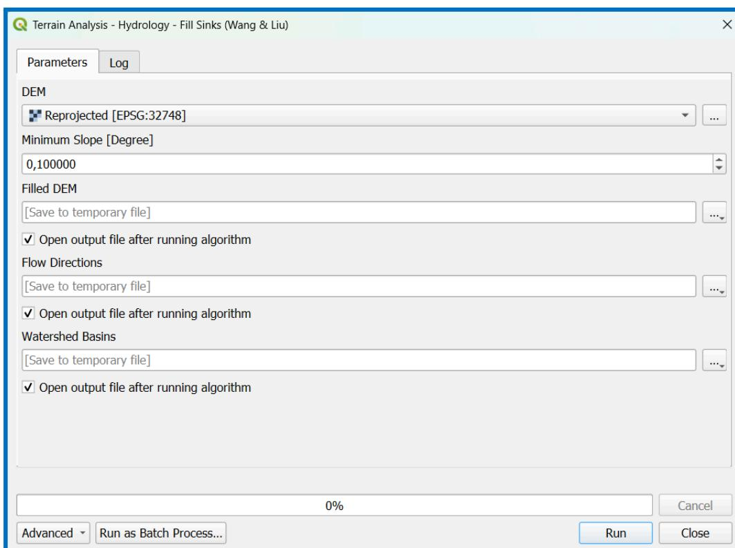
Masukkan data DEM hasil reprojeksi (UTM) ke parameter **DEM** > Parameter **Minimum Slope** dibiarkan *default* saja > *Unchecklist* atau hilangkan tanda “✓” pada output file Flow Directions dan Watershed Basins karena kita hanya menginginkan output **Filled DEM** saja > Atur output file dari Filled DEM > Klik **Run**
