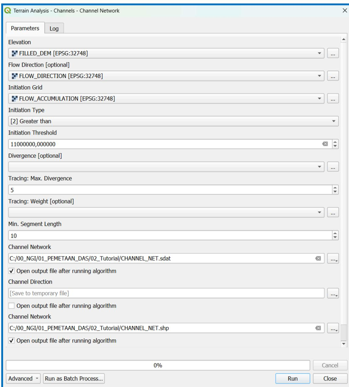
Cari tools **Channel network** pada Processing Toolbox > Input layer “**FILLED\_DEM**” pada parameter **Elevation** > Input layer “**FLOW\_DIRECTION**” pada **Flow Direction** > Input “**FLOW\_ACCUMULATION**” pada **Initiation Grid**.
