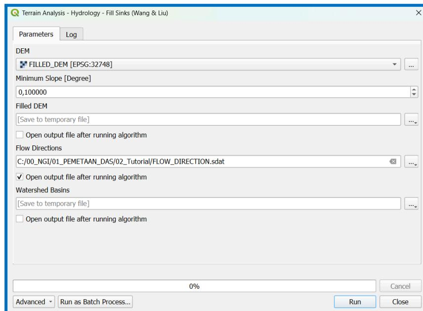
Gunakan tools **Fill Sinks (Wang & Liu)** kembali > Input layer “**FILLED\_DEM**” sebagai data utama DEM > **Unchecklist** output file dari Filled DEM dan Watershed Basins, cukup checklist **Flow Directions** > Atur file penyimpanan Anda > Klik **Run**
